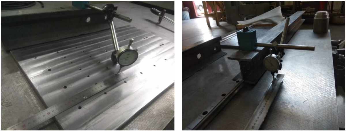
Рисунок 2.22 – Реализация схемы измерения волнистости на примере базовой плиты и направляющего рельса
