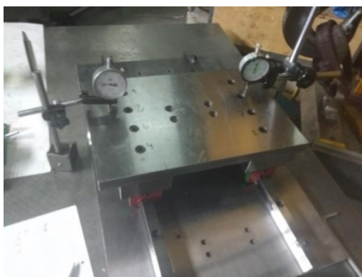
Рисунок 2.18 – Измерение пространственно-контактных деформаций плоского стыка «стол-проставка»
